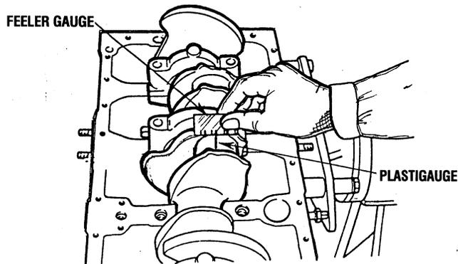
**CONNECTING ROD BEARING CLEARANCE**
