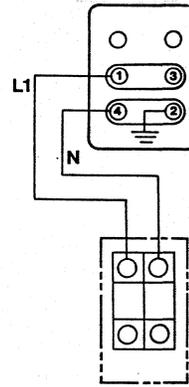
A JUMPER IS REQUIRED FOR 120V - 60 Hz
